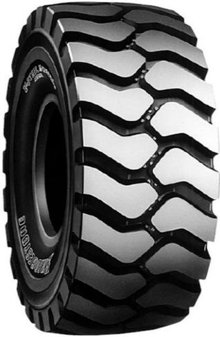
Exclusivo diseño VSNT de tracción no direccional, ofrece una óptima tracción sin sacrificar la vida útil de la banda de rodado. Carcasa reforzada, banda de rodado ancha es nuestro concepto para minimizar los cortes laterales.
